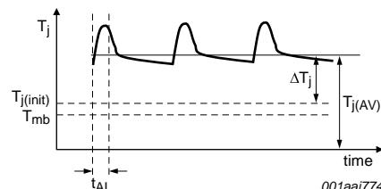
图 2-11. 在重复雪崩事件中 MOSFET 瞬时结点温度
