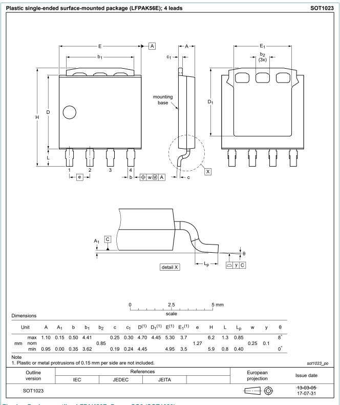
Fig. 1. Package outline LFPAK56E; Power-SO8 (SOT1023)
