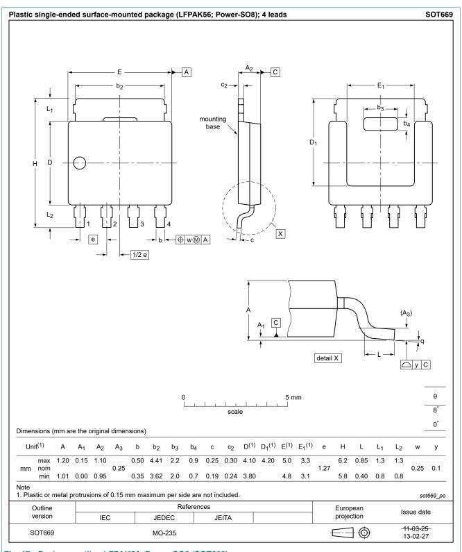
Fig. 17. Package outline LFPAK56; Power-SO8 (SOT669)
