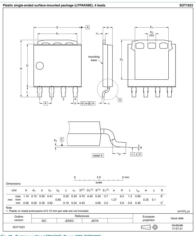
Fig. 17. Package outline LFPAK56E; Power-SO8 (SOT1023)
