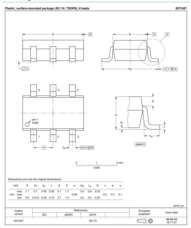
Fig. 31. Package outline SOT457 (SC-74; TSOP6)
