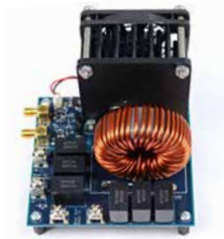
氮化镓场效应晶体管半桥电路
